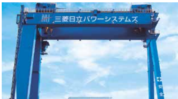
大型ガントリークレーン
