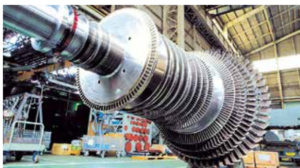
蒸気タービンローター
