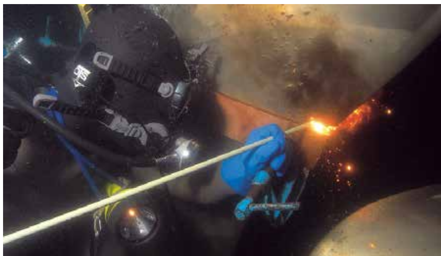
航行中に損傷を受けた大型船舶のプロペラを水中で切断します。
