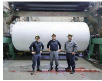
晒クラフト紙、情報用紙、半晒クラフト紙、未晒クラフト紙を生産する5号抄紙機。
